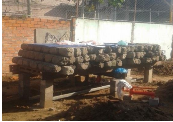
Hình 1: Thử nén tĩnh cọc hiện trường
